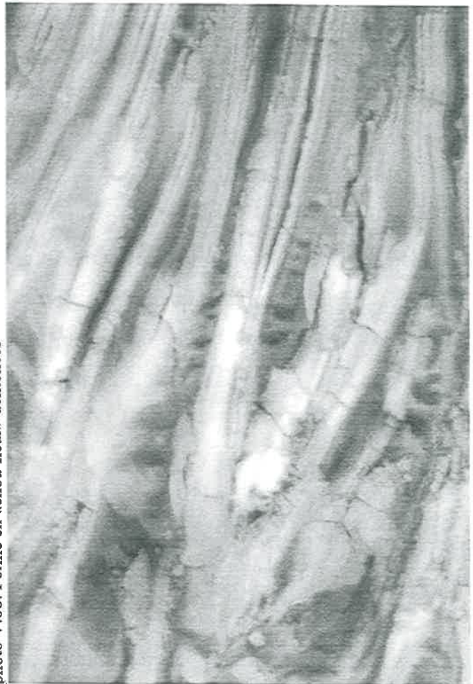
photo V.90: Présence d'un matériau fibreux reliant les différents faisceaux
