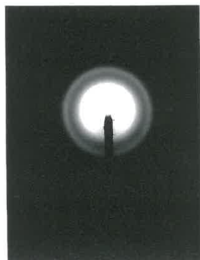
Figure IV.4 : Diagramme de microdiffraction électronique de la lépidocrocite.
