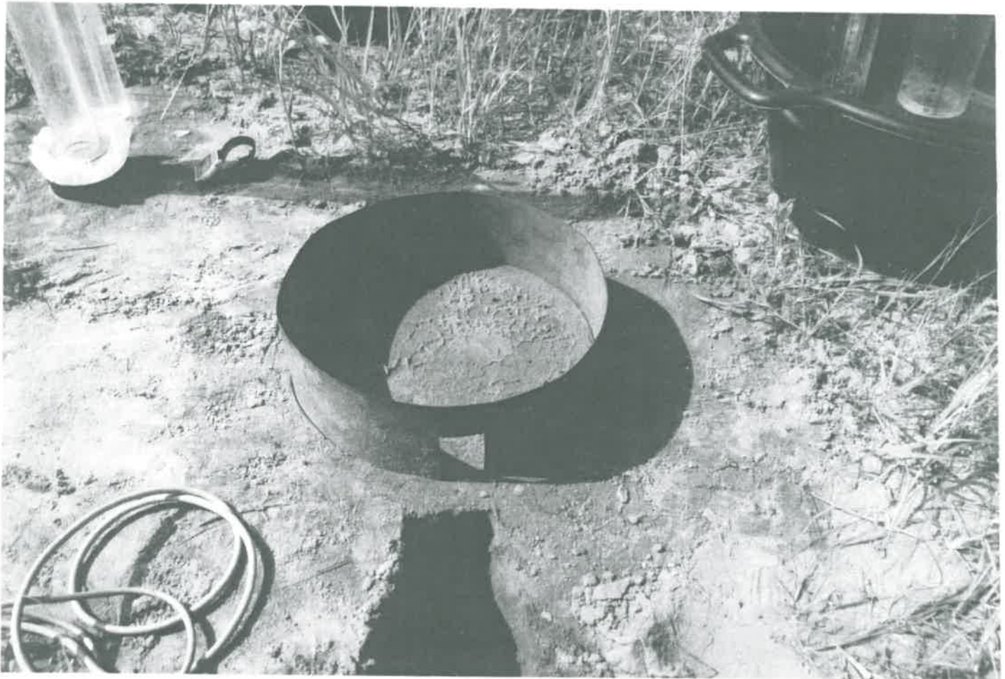
Figure 9.23. Essai pseudo-monodimensionnel : cylindre et fosse tensiométrique.
