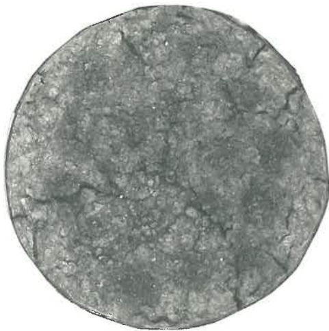
Photo4 Fissuration sur la face supérieure des massifs limoneux après l'humectation
