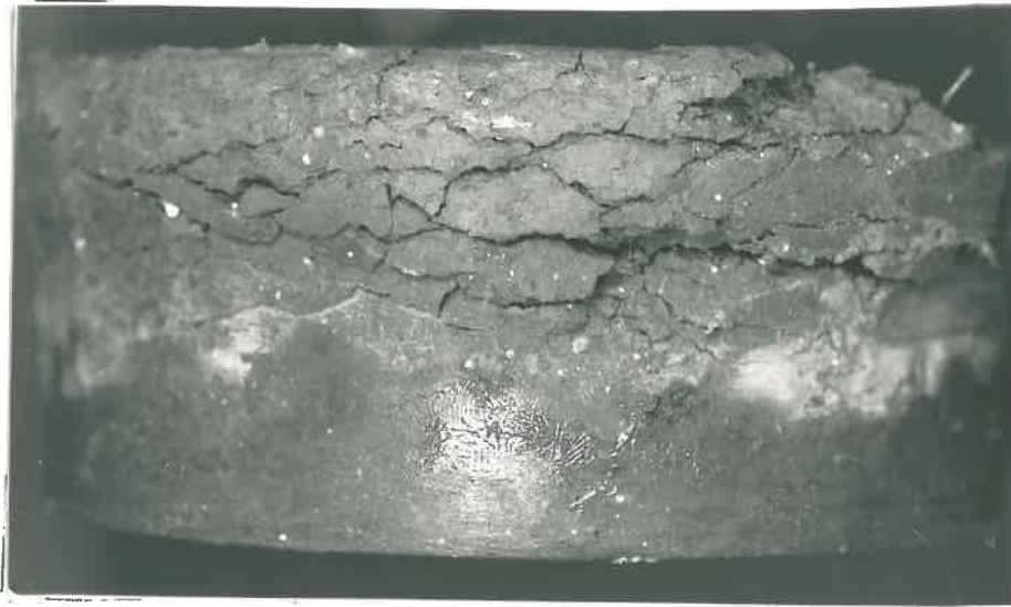
Photo2 Fissuration par cisaillement sur les massifs argileux
