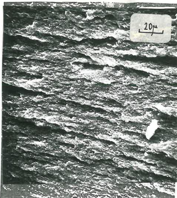
Photo 13 - Echantillon d'illite ; observation de la tranche du p \hat{a} ton mettant en \acute{e} vidence un litage grossier - MEB x 550 -
