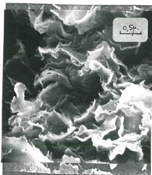
Photo 10 - Echantillon de montmorillonite ; observation de la tranche du p \hat{a} ton (faisceau d'electrons parall \grave{e} le au plan de r \acute{e} f \acute{e} rence) - MEB x 22000 -
