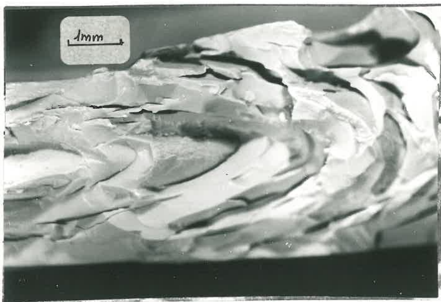
Photo 12 - Echantillon d'illite ; mise en évidence d'une fissuration concentrique très développée. Loupe binoculaire x 15.
