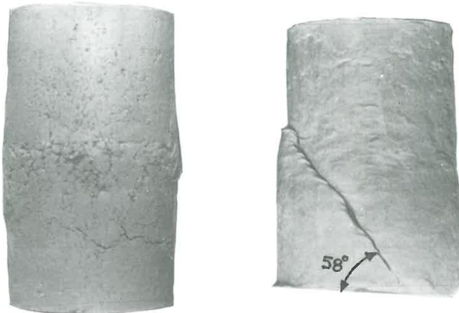
Fig. 5.11 : Rupture de l'échantillon
