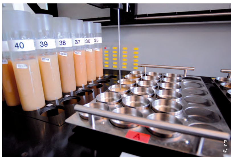
Détermination de la granulométrie d'un échantillon de sol par sédimentation selon la norme NF X 31-107.
