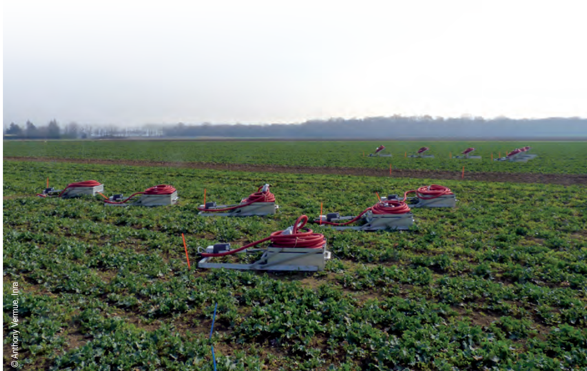
Un dispositif de mesures des gaz à effet de serre en Bourgogne.
