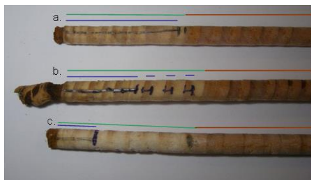
Figure 26 : Photographie de trois exemples d'aubier observé, illustrant les mesures réalisées : en vert longueur de l'aubier total, en bleu la longueur de l'aubier fonctionnel et en rouge longueur de duramen. a. aubier continu en quasi-totalité fonctionnel b. aubier fonctionnel discontinu, alternance de zones sèches. c. aubier fonctionnel ne présentant qu'une petite partie de l'aubier total
