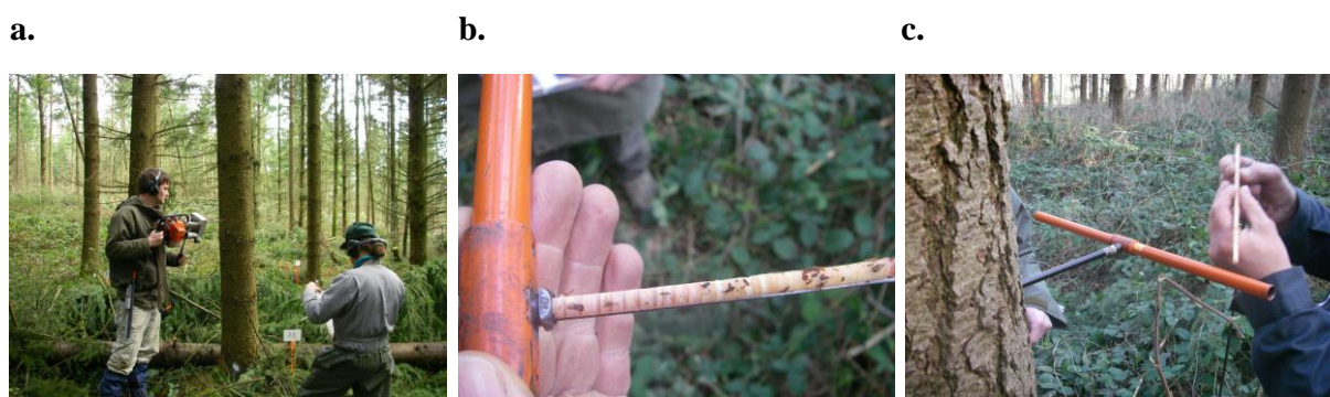
Figure 24 : Photographies du prélèvement d'une carotte de bois sur un douglas. a. utilisation du carotteur thermique, b. et c. extraction de la carotte de bois de la tarière
