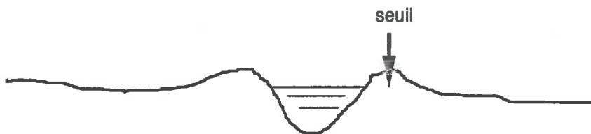
Fig. A4-4 Schématisation de la liaison maille de ruissellement - maille fluviale dans le cas où le niveau des berges est plus haut que celui des mailles de ruissellement voisines.
