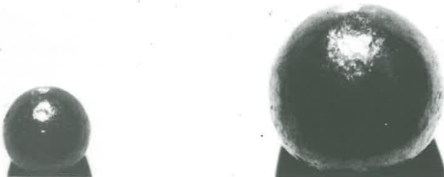
fig : A-4 : Billes de plomb type C, de diamètre 2 mm et 4 mm
