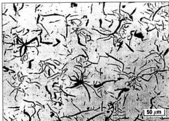
Figure 1.6 : Microstructure d'une fonte GLM [Pont A Mousson, 1986]
