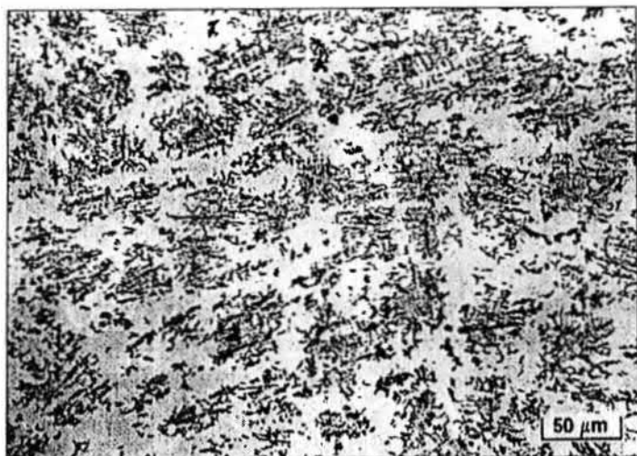
Figure 1.7 : Microstructure d'une fonte GLC [Pont A Mousson, 1986]
