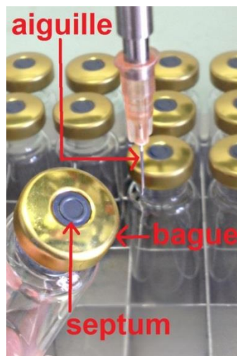
Photo de l'aiguille posée sur la rampe à vide et du vial nous pression atmosphérique
